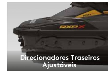
Melhora a estabilidade lateral e possui 3 posições de ajuste para se adaptar às preferências pessoais e condições de pilotagem.
